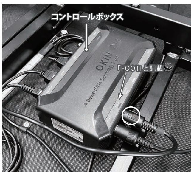
脚側のモーターのケーブル
