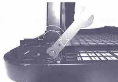
脚は4箇所あります。全ての脚を仮固定してください。設置する場所によって必要があれば付属のフェルトを接地部にお貼りください。
