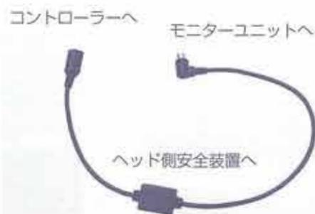
モニターユニットに接続されているコントローラーのコネクタを外し、組立て用部品として同梱されている「安全装置ケーブル」のオス側をモニターユニットに接続します。安全装置ケーブルの反対側のコネクタ（メス側）はコントローラーのコネクタと接続します。
